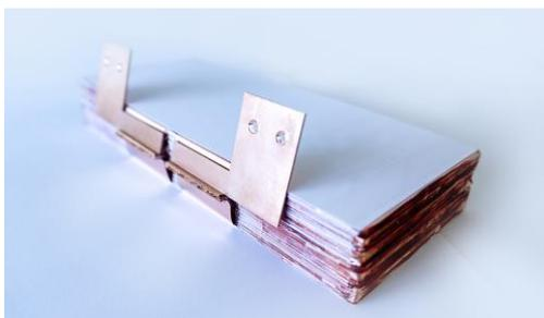
Bildunterschrift: Laser Tab Welding (Lithium-Ionen-Batteriezellproben)
